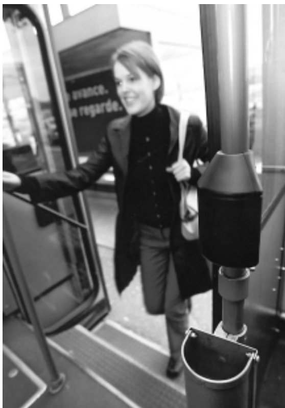
Rechts ist der Sensor für die automatische Zutrittskontrolle zu erkennen.
