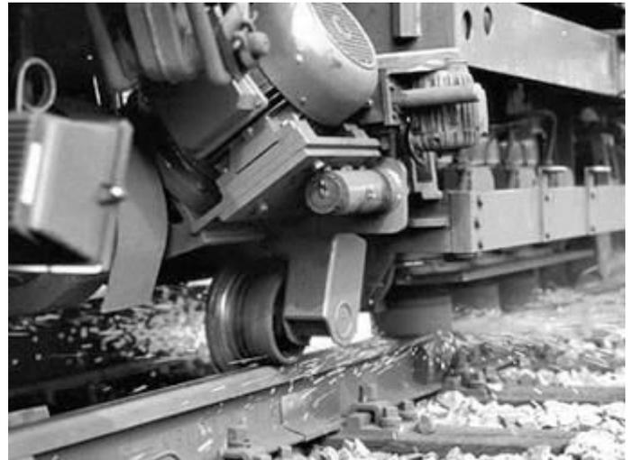
Schienenschleifmaschine, Bild © Sersa GmbH
