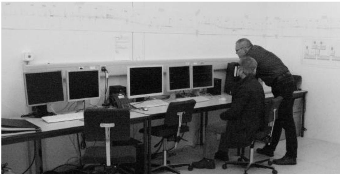
Falls die Betriebszentrale Ost am Flughafen Zürich ausfallen sollte, so könnte die Linie S26 auch von diesen Kontrollpulten aus gesteuert werden. In der Mitte der Bildschirm für die Diagnose von Störungen.
