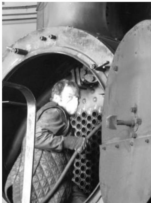
zwei Dampflokotiven in Revision stehen. Bei beiden ist der frontseitige Deckel des runden Kesselgehäuses geöffnet. Die über 100 Rohre im Dampfkessel müssen gerusst und eventuell ersetzt werden. Durch diese Rohre
