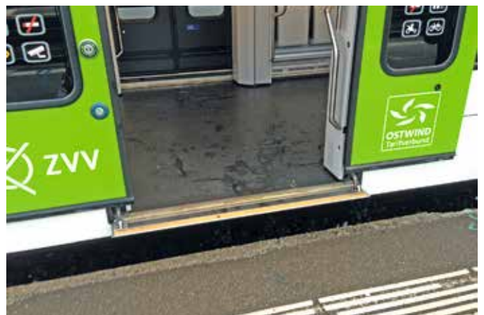
Grosser Spalt zwischen Tür der S26 und östliches Ende Bahnsteig Gleis 2 in Winterthur. Nach dem Umbau des Bahnhofs Winterthur gibt es stufenlosen Ein- und Ausstieg auf der ganzen Länge des Bahnsteig 2, Gleis 2. (Foto: Ralf Wiedenmann, IG Tösstallinie)
