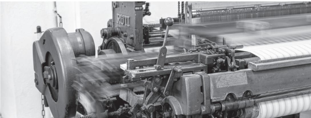
Webmaschine aus der Webmaschinenfabrik Rüti
